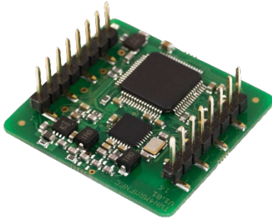
TWN3 Mini Reader MIFARE NFC top view*
